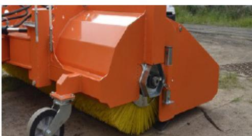
Уже в базовой комплектации для увеличения срока службы щеточных дисков мы устанавливаем специальный механизм компенсации износа. С его помощью осуществляется **регулировка прижатия щетины к очищаемой поверхности** по мере стирания щеточных дисков. В зависимости от модели изделия, такая система может быть реализована за счет:
