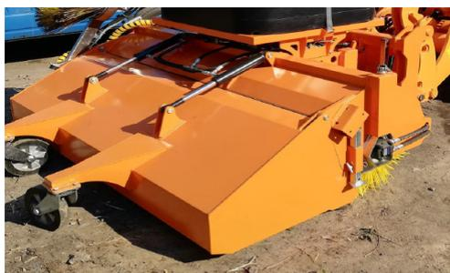
Для еще более эффективной очистки мы предлагаем съемный бункер для сбора мусора с **гидравлическим механизмом подъема**.
