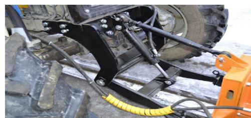
Для тракторов без фронтального оборудования опционально мы можем предложить универсальный механизм подъема.
