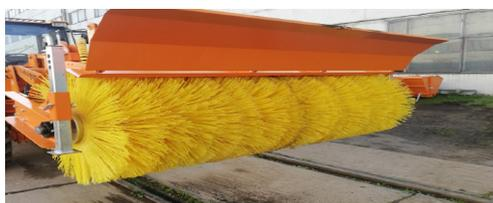
Для предотвращения загрязнения лобового стекла машины при работе с щеткой мы предусмотрели специальный съемный защитный козырек, монтируемый на фронтальную часть изделия.
