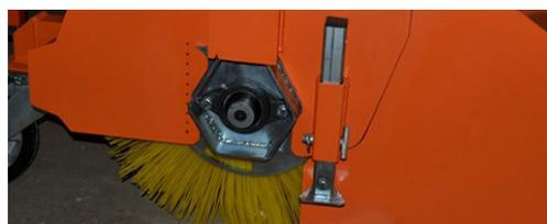
Для быстрого и удобного монтажа щетки, а также для ее надежного хранения и безопасной транспортировки мы разработали специальные опорные стойки. Они надежно фиксируются пальцами и при работе не мешают.
