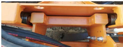
Очищаемая поверхность редко бывает ровной. На пути спецтехники встречаются люки, ямы, деформированные лежащие полицейские и прочее. Для того, чтобы безопасно, но в то же время эффективно осуществить очистку подобного участка нашим конструкторским отделом был разработан плавающий механизм, устанавливаемый уже в базовой комплектации.
