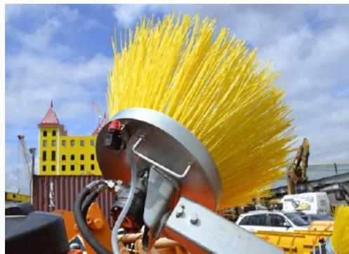
Лотковая щетка является идеальным подборщиком мусора из труднодоступных мест, таких как прилотковые зоны, узкие дорожные ниши и прочее. Она приводится в действие за счет гидравлической системы трактора и оснащается отдельным гидромотором. Её подъем/опускание осуществляется механически. Монтируется она непосредственно на основную щетку, причем **можно установить сразу 2 подобных лотковых щетки**.
