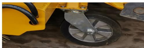
Мы устанавливаем на щеточное оборудование качественные **опорные колеса с прочной системой крепления**.
