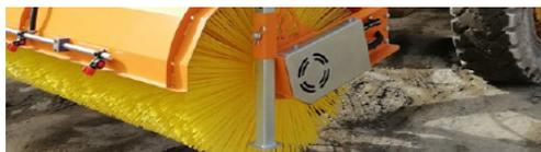
Конструкторами нашей компании было принято решение расположить **гидромотор внутри вала щетки**, при этом защитив его дополнительно металлическим кожухом. Это, несомненно, обеспечивает безопасность гидромотора от ударов и других внешних воздействий.
