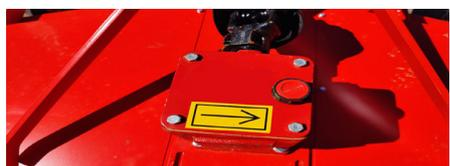
Инженерами нашего конструкторского отдела для бесперебойной работы косилки был разработан и установлен редуктор собственного производства. Также мы предусмотрели механизм натяжения ремней, который позволяет, при необходимости, регулировать натяжение ремней, а не осуществлять их замену.
